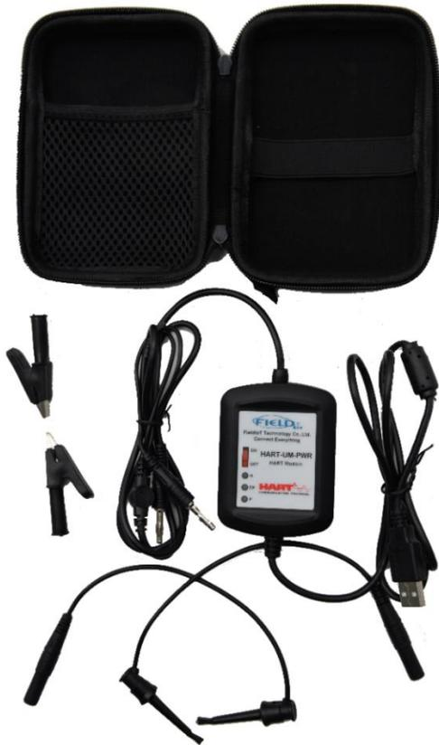
USB接口HART信号调制解调器基于HART调制解调器芯片A5191设计，HART的数据发送与获取完全符合基金会物理层标准对主站物理层的要求，HART数据采用完全透明的传输方式。USB接口HART信号调制解调器是符合HART协议的现场设备与运行组态软件的PC机间信号转换器。
